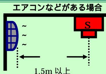
エアコンや換気扇の吹き出し口から 1.5m 以上離して取付けます。
